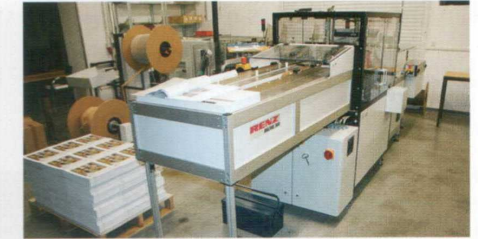
Die Klebebinde-Linie Heidelberg EB 4000 (l.) kann auch für die Vorfertigung von Ring-Wire-gebundenen Broschüren dienen. Die von ihr gefertigten Blocks werden anschließend von der Renz Inline 360 (r.) gestanzt und gebunden.
