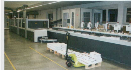
Die Klebebinde-Linie Heidelberg EB 4000 (l.) kann auch für die Vorfertigung von Ring-Wire-gebundenen Broschüren dienen. Die von ihr gefertigten Blocks werden anschließend von der Renz Inline 360 (r.) gestanzt und gebunden.
